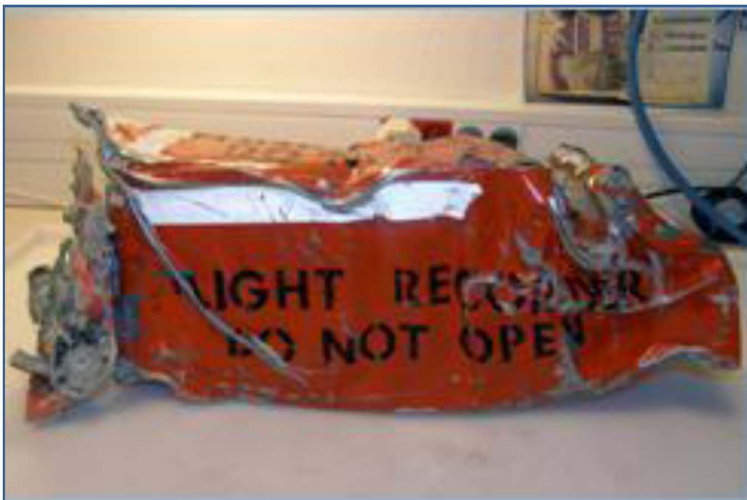
Fig. 37 : Enregistreur de données de vol (FDR).
