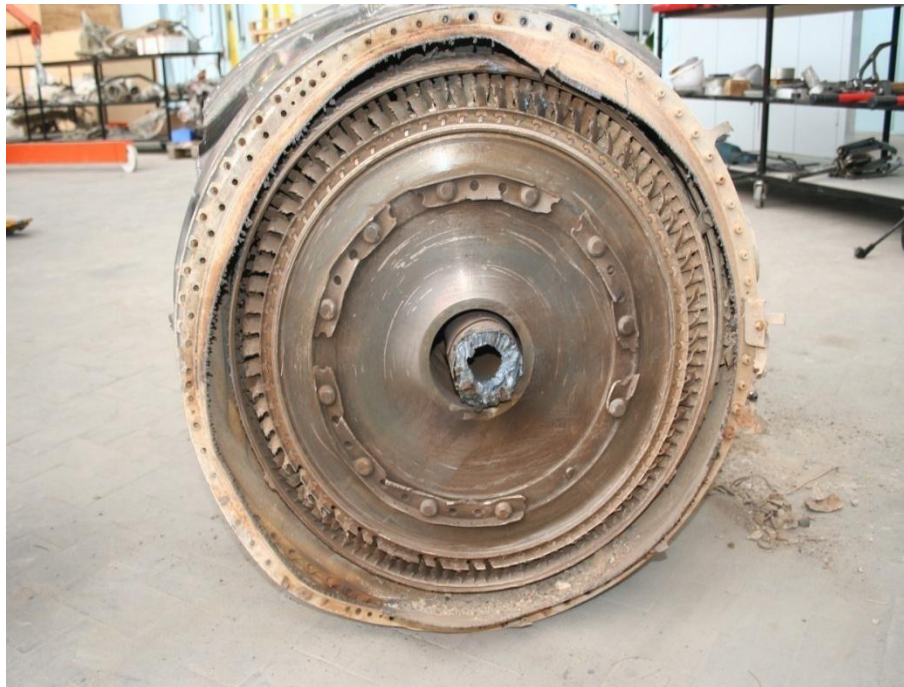
Fig. 44 : Compresseur haute pression du moteur n° 2.
