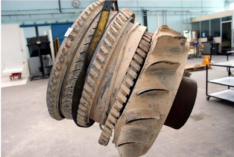
Fig. 41 : Compresseur basse pression du moteur n° 1.
