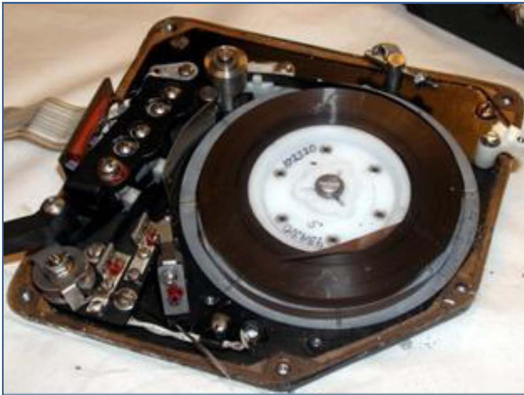
Fig. 36 : Bande magnétique et mécanisme du CVR.
